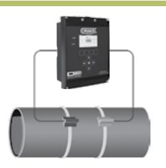
Nicht-invasives Durchflußmessgerät mit Clamp-on Technik, geeignet für nahezu alle Flüssigkeiten mit weniger als <10% Feststoffe oder Gas.
